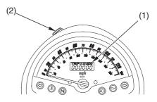
(1) odometer/tripmeter display
